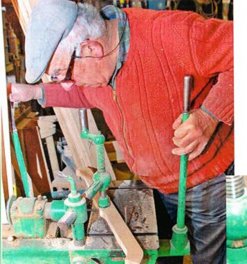
Pour définir l'angle en biais réalisé au moyen de la mortaiseuse, le gabarit est constitué de deux pointes qui viennent prendre place dans des logements sur la table de la mortaiseuse, réalisés par Aimé, encore une astuce
